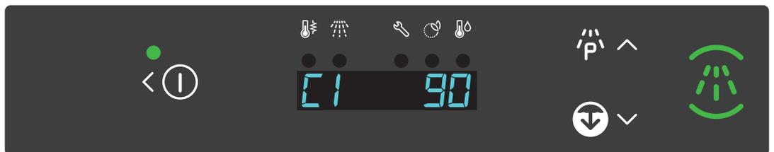
Si, por el contrario, se ha establecido una temperatura mínima de lavado (función que solo puede activar un técnico autorizado), y la temperatura en la cuba es inferior a dicho límite, el lavavajillas pasa a la fase de calentamiento y en la pantalla aparece el mensaje "HEAT" alternándose con la pantalla de temperatura:
