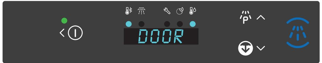
Si la puerta se cierra en 10 segundos, el ciclo se reanuda. Si la puerta permanece abierta más de 10 segundos, el ciclo se anula. Cuando la puerta está abierta aparece el mensaje "DOOR" y la tecla **START** azul parpadea si el ciclo de lavado se ha suspendido; sin embargo, en los otros casos la tecla **START** parpadea en color amarillo:
