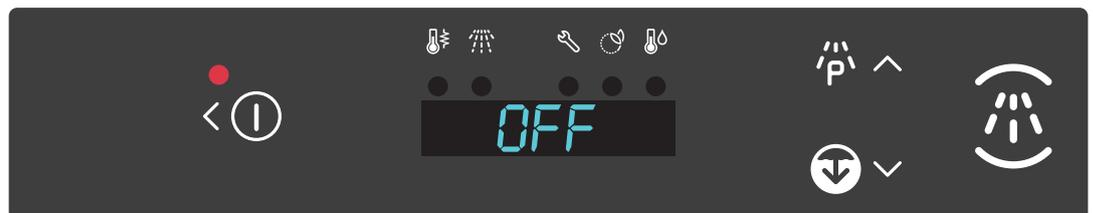
El testigo "1" permanece encendido en rojo durante el tiempo que el lavavajillas recibe corriente estando apagado (stand-by).
